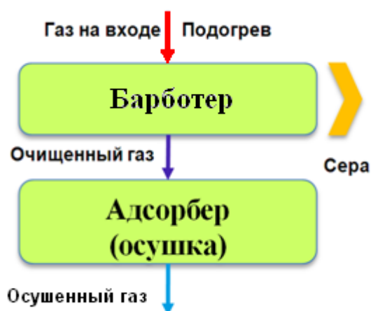
Рисунок 1. Общий принцип работы системы сероочистки
